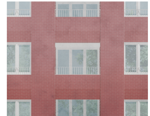
Abb. 165: Massive Brüstung der Loggia
